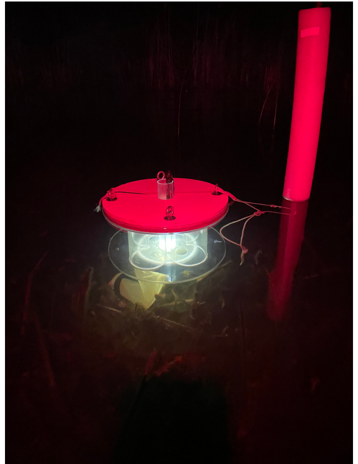
Piège lumineux larvaire in situ pendant la nuit. La lumière provoque une phototaxie chez les larves de poisson, ce qui permet l'échantillonnage. Crédit photo : J. Powell
